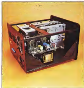
Come memoria di massa vengono impiegati drive da 5 pollici di fabbricazione Nord
